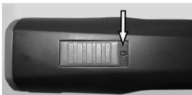
Abb. 4 Schiebeschalter in AUS-Position („0“)
